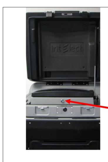
Using the Barrel key, lock the DS200 monitor in place
